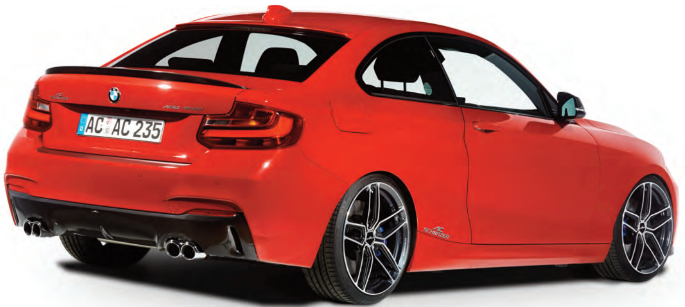
Dachheckspoiler, Heckschürzenschutzfolie, Carbon Heckdiffusor, Carbon Spiegel Cover, Schalldämpfer mit zwei „Racing Evo“ Endblenden
