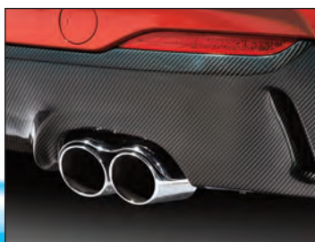
Carbon Heckdiffusor, Schalldämpfer mit zwei „Racing Evo“ Endblenden
