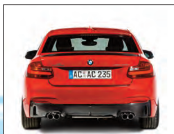
Dachheckspoiler, Heckschürzen-Schutz- folie, Carbon Heckdiffusor, Schalldämpfer mit zwei „Racing Evo“ Endblenden
