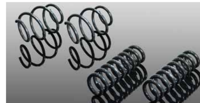
Fahrwerksfedernsatz Tieferlegung vorne: ca. 20 - 25 mm, hinten ca. 15 - 20 mm)
