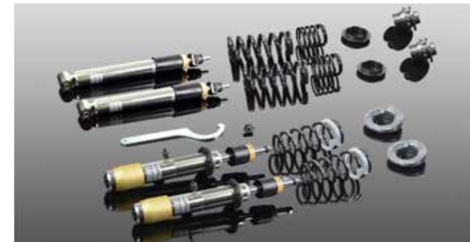
RS Gewindefahrwerk, höhenverstellbar und einstellbar in Druck- und Zugstufe
