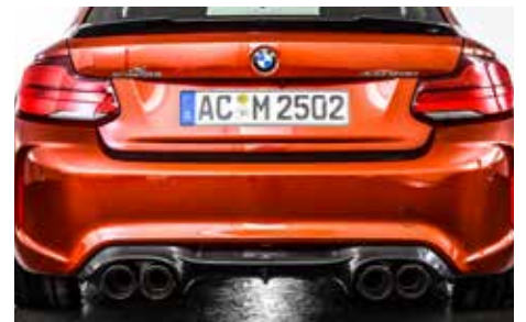
Heckschürzenschutzfolie, Carbon Heckdiffusor, Schalldämpfer mit „Sport“ Auspuffendblenden, Carbon
