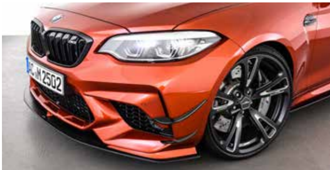
Frontsplitter und Carbon Frontsidewings
