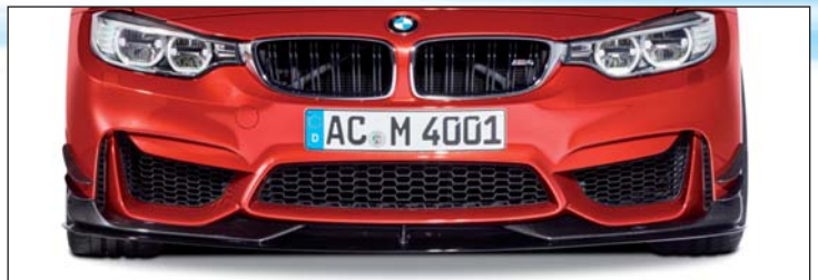
Carbon Frontspoiler, Frontsplitter (Rennsportversion), Carbon Front Side Wings 2 Stück je Seite (Rennsportversion)
