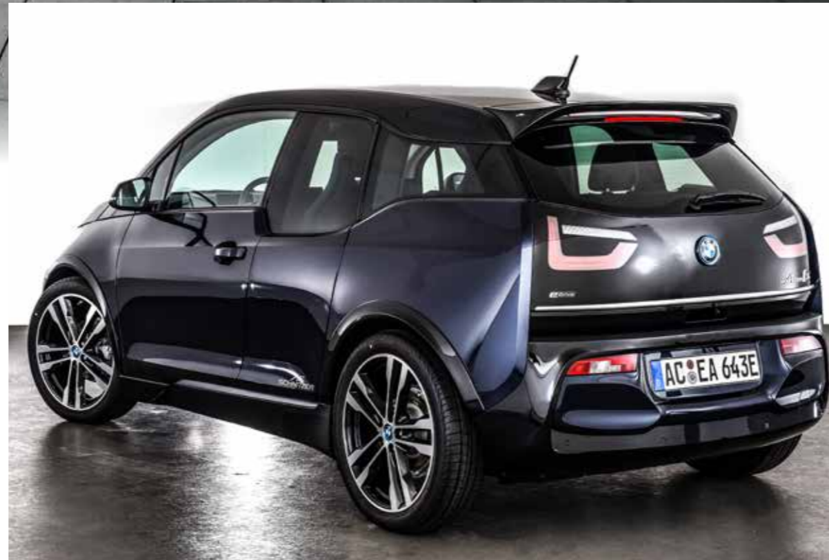
Spurverbreiterung 12 mm je Seite, Dachheckflügel, Heckschürzenschutzfolie, Schriftzüge
